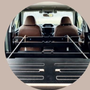
DE 7. Einfache Vorbereitung des Schlafplatzes – Matratzen und Roste wurden je nach Fahrzeugtyp in mehreren Varianten entworfen. Der Umgang mit ihnen ist einfach, sie passen in eine große Menge von Fahrzeugen. Matratze und Rost werden innerhalb von wenigen Sekunden ausgelegt wie ein Leporello, mit der Möglichkeit sich selbstständig zu stützen.
