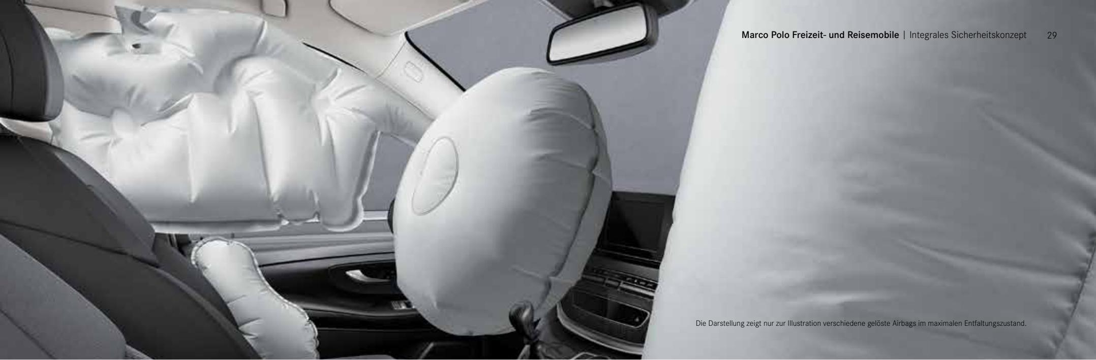
Die Darstellung zeigt nur zur Illustration verschiedene gelöste Airbags im maximalen Entfaltungszustand.
