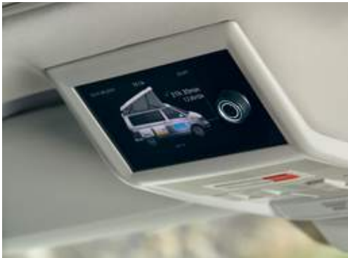
Kontrolle der Energie- und Frischwasserversorgung
