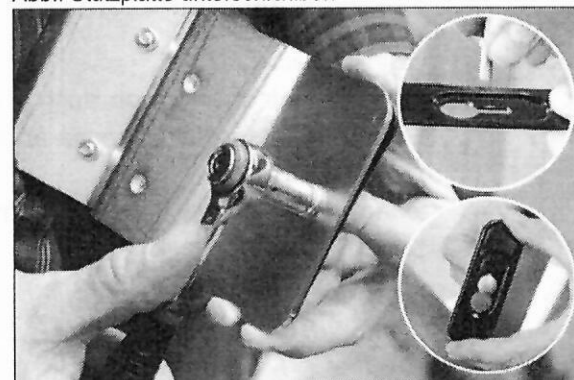
Abb.: Klebefläche für die Stützplatte markieren
