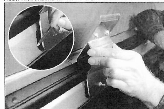
Abb.: Klebefläche für die Stützplatte markieren
