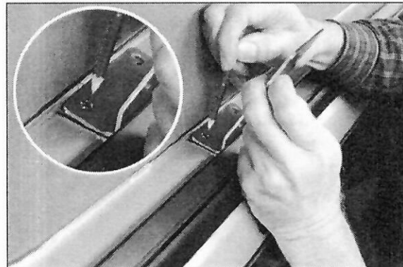
Abb.: Bohrlöcher anzeichnen
