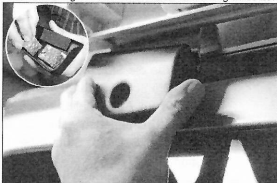
Abb.: Unterlegscheibe, Mutter festschrauben, Abdeckkappe
