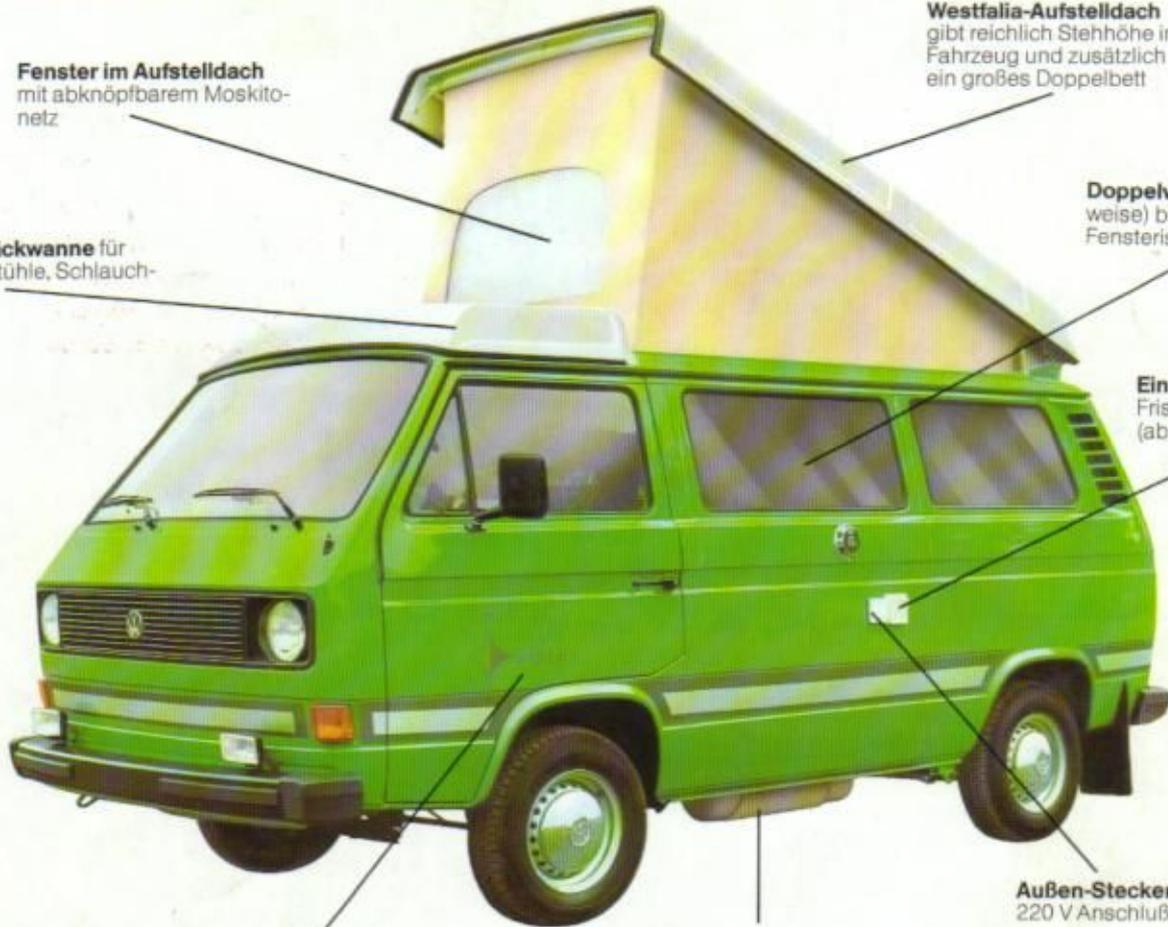
**Einfüllstutzen** für 55 Liter Frischwassertank (abschließbar)
