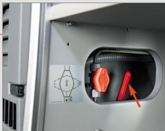
Entleerungsventil Abwassertank ca. 32 l
