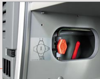
Abwassertankentleerung im linken Küchenschrank
