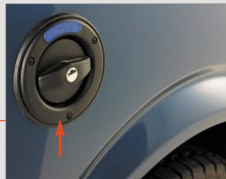
Einfüllstutzen Frischwasser und Dusche
