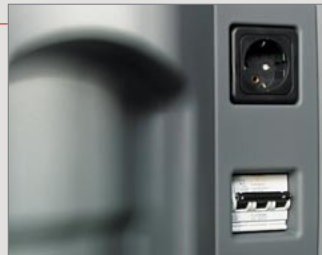
Fehlerstromschutzeinrichtung für 230-V-Bordelektrik
