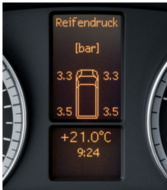
Das automatische Reifendruck-Kontrollsystem.
