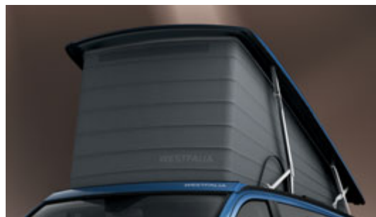
Elektrohydraulisches Aufstelldach EASY UP.
