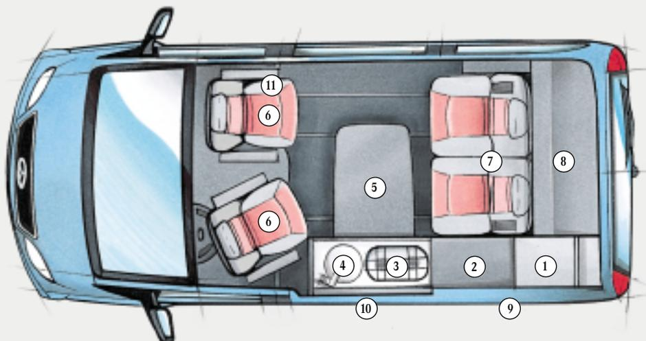
1. Multifunktions-/Kleiderschrank mit Staufächern und Fach für die Gasflasche 2. 40-Liter-\*\*\*-Kompressorkühlbox
