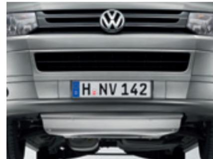
Der **Motorunterfahrschutz**. Er bietet ein Höchstmaß an Schutz für den Motor und das Getriebe. Auf Wunsch kann auch der Tank geschützt werden. Bitte beachten Sie, dass sich dadurch die Nutzlast des Fahrzeugs verringert.
