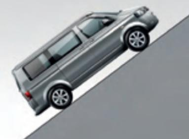
Die **Steigfähigkeit**: 37°. Serpentin und ansteigendes Gelände nimmt der California mit 132-kW-Motor<sup>1)</sup> und 3.000 kg Fahrzeuggewicht nahezu mühelos bis zu einer Steigung von 37°.
