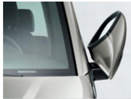
Die **elektrisch anklappbaren Außenspiegel**. Serienmäßig sind die Spiegel elektrisch verstell- und beheizbar. Auf Wunsch sind sie auch elektrisch anklappbar. Je nach Modell ist das Spiegelgehäuse lackiert oder unlackiert.
