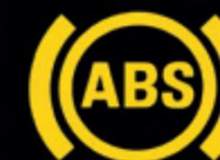
Das **Antiblockiersystem (ABS)**. Es verhindert ein vollständiges Blockieren der Räder und verbessert so die Lenkbarkeit des Fahrzeugs bei einer Vollbremsung erheblich.
