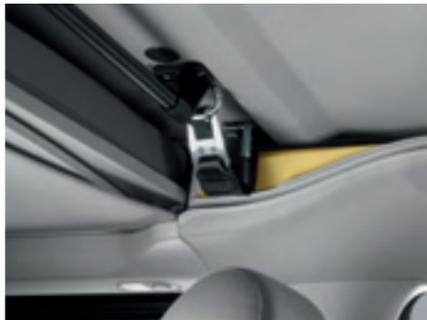
Das **manuelle Aufstelldach**. Während der Fahrt ist das Aufstelldach sicher in zwei Halterungen verankert. Am Urlaubsort kann es mit wenigen Handgriffen hochgestellt werden.
