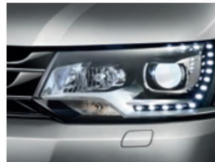
Die **Bi-Xenon-Scheinwerfer**. Sowohl das Ablend- als auch das Fernlicht werden über die Bi-Xenon-Scheinwerfer erzeugt. Das erweitert das Sichtfeld und erhöht die Sicherheit. Energiesparende LED-Leuchten übernehmen das Tagfahrlicht.
