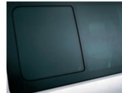
Das **Schiebefenster links**. Für Frischluft sorgt das serienmäßige Schiebefenster auf der linken Seite des Fahrgastraumes. Es kann von innen mit einem Handgriff geöffnet werden. Ein Schiebefenster rechts ist optional erhältlich.
