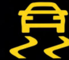
Das **elektronische Stabilisierungsprogramm** inkl. elektronischer Differenzialsperre (EDS). Die Elektronik verhindert ein Ausbrechen des Fahrzeugs, indem sie kontrolliert in das Brems- und Motormanagement eingreift.\*
