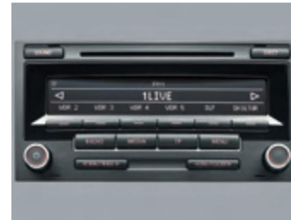
Das **Radiosystem „RCD 310“**. Es verfügt über alle Funktionen des „RCD 210“, bietet darüber hinaus aber acht Lautsprecher, eine AUX-IN-Schnittstelle im Handschuhfach, Antennendiversity und ein großes, ParkPilot taugliches Display.
