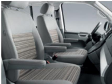
Die **Drehsitze**. Die ergonomischen Sitze für Fahrer und Beifahrer sind mit Armlehnen und Lendenwirbelstütze ausgestattet. Sie bieten guten Seitenhalt und sind um ca. 180° drehbar.
