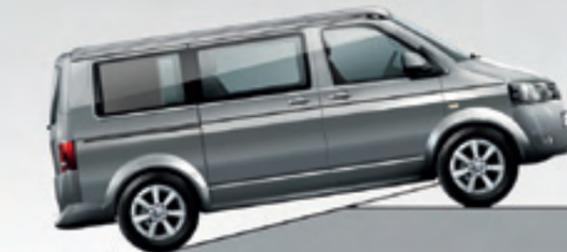
Der **Rampenwinkel**: 14°. Je mehr Spielraum zum Boden, desto mehr Spielraum bei der Campingplatzsuche. Selbst Kuppen mit einem Rampenwinkel von bis zu 14° überwindet der California spielend. Gemessen mit Serienausstattung und bei voller Beladung.
