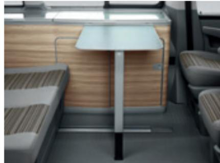
Die flexible Arbeitsplatte. Der verschiebbare Tisch ist an der Küchenzeile eingehängt und kann mittels eines ausklappbaren Standbeins aufgestellt werden.
