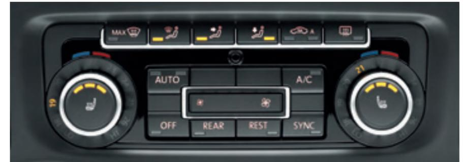
Die **Klimaanlage „Climatronic“**. Dieses System bietet eine 3-Zonen-Temperaturregelung für Fahrer, Beifahrer und Passagiere im Fahrgastraum. Es erkennt die Stärke der Sonneneinstrahlung und die Außentemperatur und führt entsprechend mehr oder weniger kühle Luft zu. Die automatische Umluftschaltung und der Luftgütesensor schaffen ein angenehmes Klima.
