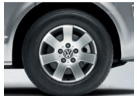
Die **rollwiderstandsoptimierten Reifen**. Der California mit BlueMotion Technology nimmt den Kontakt zur Straße über rollwiderstandsoptimierte Reifen auf. Der geringere Rollwiderstand reduziert den Kraftstoffverbrauch und damit den CO<sub>2</sub>-Ausstoß.
