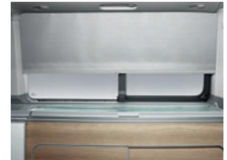
Die Verdunkelung im Wohnraum. Aus der Dachrahmenverkleidung ausziehbares Rollos schließen an den Fensterholmen blickdicht ab.
