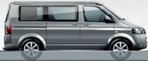
Die **Wattiefe**: bis zu 300 mm. Nach starken Unwettern durchqueren Sie mit dem California überflutete Straßen oder stehende Gewässer mit einer Tiefe von bis zu 300 mm problemlos. Gemessen bei voller Beladung und maximal 30 km/h.
