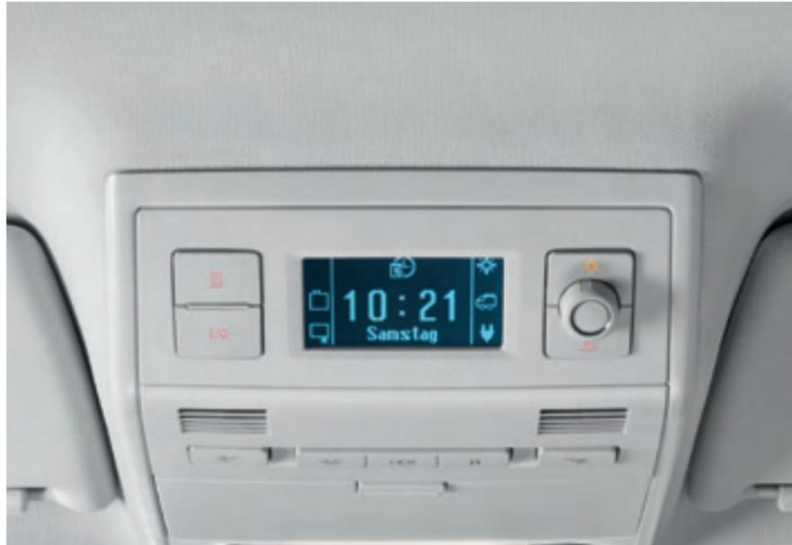
Das **zentrale Bedienfeld**. Über dem Innenspiegel platziert, verfügt es über ein LCD-Display für die Außentemperatur, den Batterieladezustand, den 230-V-Anschluss, den Betriebszustand der Kühlbox und den Füllstand von Frisch- und Abwassertank. Die Standheizung lässt sich ebenfalls über das Bedienfeld steuern; sie arbeitet unabhängig von der Heizungs- und Belüftungsanlage und ist auch über die Funkfernbedienung aktivier- bzw. deaktivierbar.
