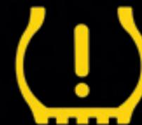
Die **Reifenkontrollanzeige**. Bei Druckabweichungen in einem der vier Reifen erscheint ein Warnsymbol: ein Hinweis, schnellstmöglich den Reifendruck zu überprüfen.
