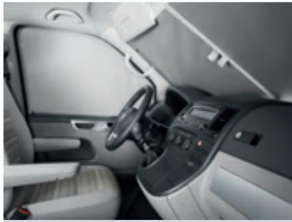
Die **Verdunkelung im Fahrerhaus**. Im California Comfortline lässt sich die Frontscheibe mit zwei Rollos verdunkeln; im Beach mit einem gespannten Stoff. Die Seitenscheiben beider Modelle werden mit Stoffblenden abgedeckt.
