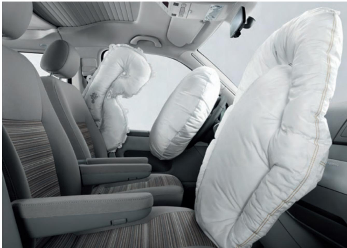
Die **Airbags**. Wer auf lange Reisen geht, will immer optimal geschützt sein. Deshalb ist der California serienmäßig nicht nur mit einem Fahrer- und einem Beifahrerairbag ausgestattet, sondern auch mit Seiten- und Kopfairbags an der B-Säule. Der Beifahrerairbag kann mit dem Fahrzeugschlüssel deaktiviert werden.
