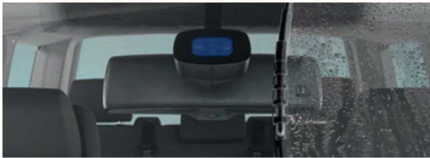
Der **automatisch abblendende Innenspiegel** und der **Regensensor**. Der Innenspiegel blendet bei zu hellen Scheinwerfern des Fahrzeugs hinter Ihnen selbsttätig ab. Das bringt Ihnen eine bessere Sicht nach vorn. Zusätzlich befindet sich im Spiegel ein Regensensor, der bereits leichten Regen auf der Windschutzscheibe registriert und sofort die Scheibenwischer aktiviert.
