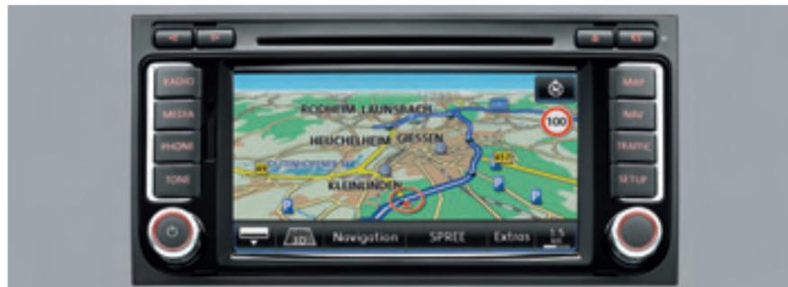
Das **Radio-Navigationssystem „RNS 510“**. Dieses System bietet alle Funktionen des „RNS 315“, verfügt jedoch über einen Farbtouchscreen mit einer Diagonalen von über 16 cm. Auf der mitgelieferten DVD ist das Kartenmaterial für Westeuropa gespeichert. Es kann auf die 30-GB-Festplatte des „RNS 510“ kopiert werden, sodass Sie gleichzeitig über die acht Lautsprecher Ihre Lieblings-CD hören können. Alternativ lässt sich das Gerät per Sprachbefehl bedienen.
