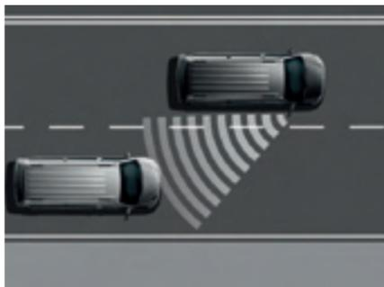
Der **Spurwechselassistent „Side Assist“**. Sollte sich beim Spurwechsel ein von den Sensoren erkanntes Fahrzeug im nicht einsehbaren Bereich befinden, warnt Sie das System über eine Anzeige im Außenspiegel.
