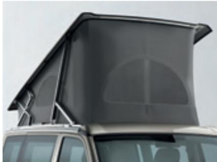
Das **Bugfenster**. Das elektrohydraulische Aufstelldach kann vorne auf Wunsch mit einem halbkreisförmigen Fenster ausgestattet werden. So müssen Sie morgens nur den Kopf heben, um den Sonnenaufgang zu genießen.
