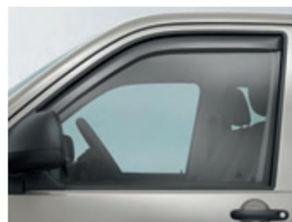
**Die Wind- und Regenabweiser.** Bei der Fahrt mit leicht geöffnetem Fenster werden Spritzwasser und Windgeräusche wirksam reduziert, bei seitlich einfallender Sonne wird Blendschutz gegeben. Die Abweiser sind ohne Bohren und Kleben zu montieren.
