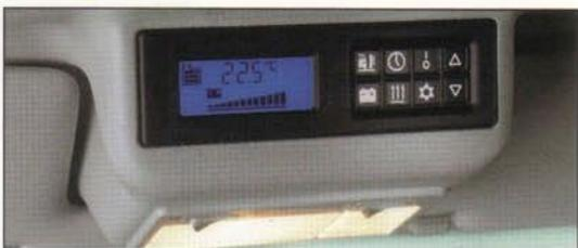
Den Komfort im Visier: im Fahrerblickfeld angeordnete Zentralelektronik mit beleuchtetem Display.
