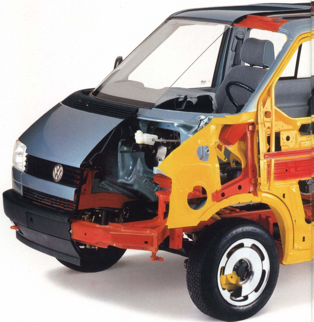
Energieabsorbierender Frontbereich, Verstärkungen an den Seiten und eingeklebte Scheiben erhöhen die Sicherheit
