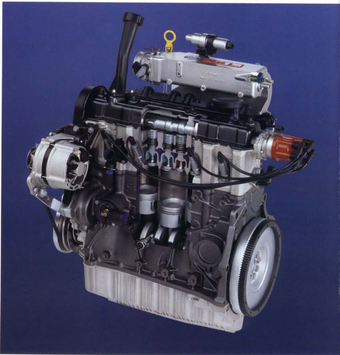
Zugstarker 5-Zyl.-Ottomotor, 2,5 l, 81 kW
