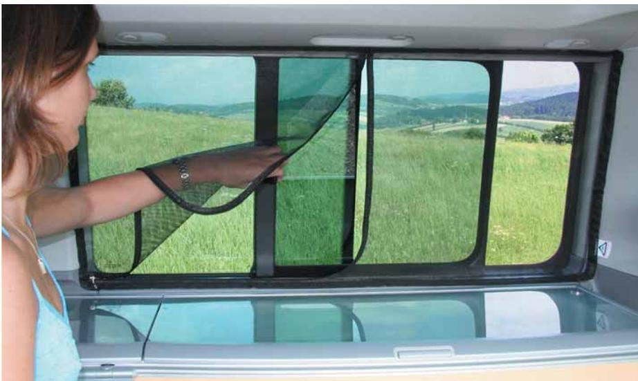
Die engmaschigen Moskitonetze für die Schiebefenster haben einen L-Reißverschluss, so dass die Bedienung des Schiebefensters und Rollos gewährleistet bleibt, ohne das Netz abnehmen zu müssen.
