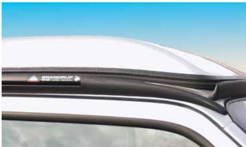
Der Frontspoiler leitet nicht nur das Regenwasser perfekt ab, sondern auch Windgeräusche des Aufstelldaches: Beim Fahren wird es innen leiser.
