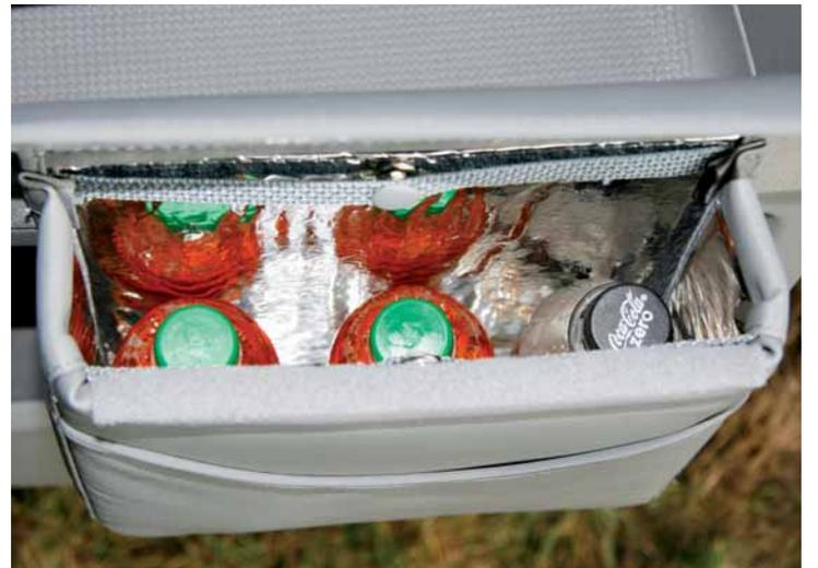
Die Multibox wird in der oberen Ablagemulde mit Klettverschluss eingehängt und unten mit Klettverschluss gesichert. Vier 0,5-Liter-Flaschen können abgelegt werden. Volumen ca. 3,86 Liter.
