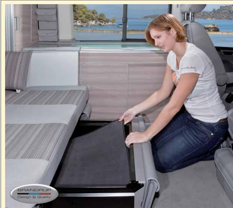
Die Geräuschdämm-Matte (Boden) wird in die Schublade eingelegt.
