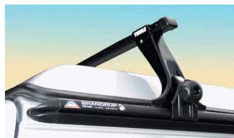
*Sichere und einfache Befestigung von geprüften Dachlastenträgern mit Stützfüßen für Regenrinnen. Schnell abgenommen, wenn man das Dach öffnet.*
