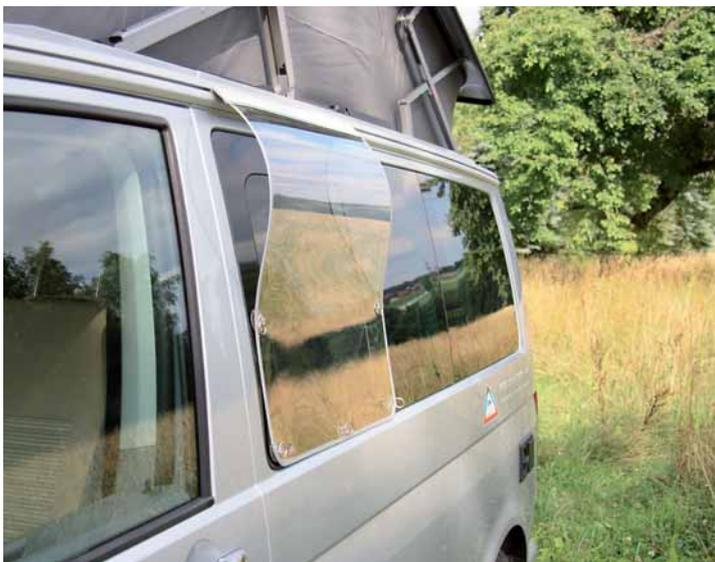
AIRSCREEN VW-T5 wird in die serienmäßig vorhandene Aluschiene des VW California oder bei allen anderen VW-T5 in TOP-RAIL (vgl. Seite 54-55) eingezogen. Bei Regen wird mit den zwei Saugnapf-Reihen die optimale Belüftungsposition eingestellt.
