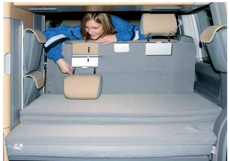
Das California Faltbett ist dreiteilig und kann auf dem Heckpolster gefaltet abgelegt werden. Bei Bedarf entfaltet man es mit einem Handgriff nach vorn.
