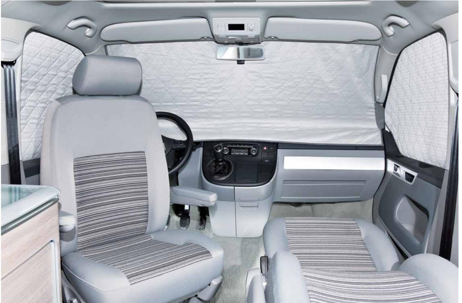
Die Befestigung an den Seitenfenstern erfolgt mit Klettverschluss. Die Befestigung im Fahrerhaus ist wie bei ISOLITE. An der Windschutzscheibe wird eine Lage ISOLITE wie gewohnt angebracht. Daran ist oben eine hochisolierende ISO-TOP Extrem Matte angenäht, die mit zwei Klettverschlussbefestigungen an den A-Säulen fixiert wird. Die Isolationswirkung ist bei allen Bedingungen hervorragend.
