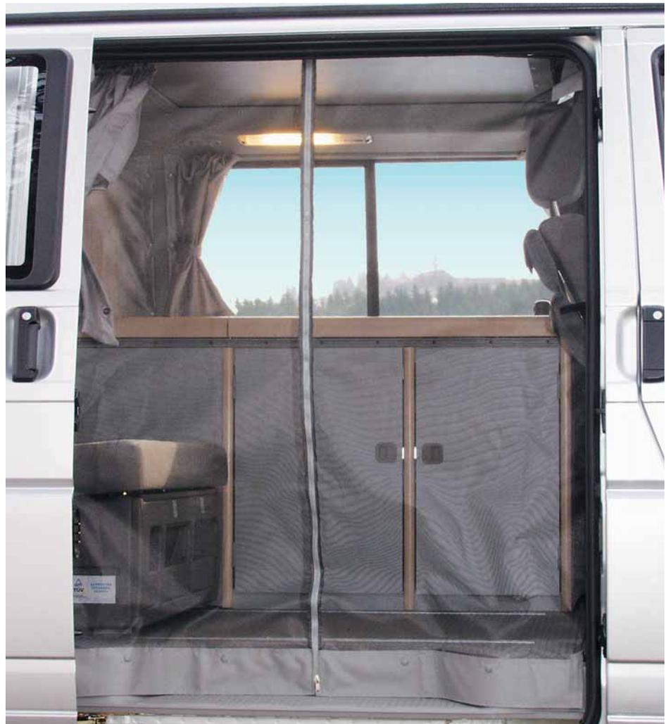
Speziell für VW-T4 California entwickelt. Das Netz für die Schiebetür-Öffnung wird oben zwischen Tür und Gardine angebracht: Die Gardine lässt sich leicht zuziehen. Der Eingangsreißverschluss ist beidseitig bedienbar. Alle Moskitonetze sind waschbar.
