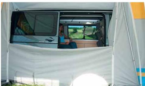
Die Rückwand lässt sich stufenlos herunterlassen, wenn es unter dem Auto zieht. Die Rückwand lässt sich sogar in zwei Positionen zur Seite rollen.
