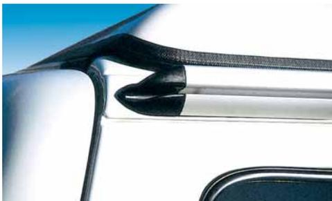
Der Heckabschluss betont die harmonische Linienführung und leitet das Regenwasser seitlich ab: Das Wasser kann nicht ins offene Heck fließen.
