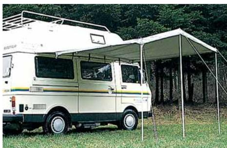
*Nur 3 Stäbe + Fahrzeugbefestigung (California T5 mit oder ohne Adapter): Das Vordach ist fertig! Die Vorderwand kann auch eingezogen werden.*
