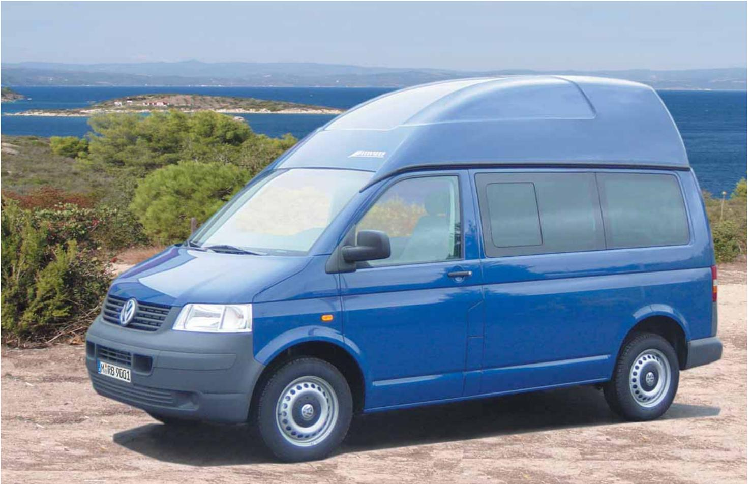
Das TOP-RAIL T5 Aluminiumprofil ist auf die Karosserieform des VW-T5 vorgebogen und passt nur an diese Fahrzeuge. Die Montage an den T5 California wäre zwar möglich, seitens der Volkswagen AG ist derzeit die Entfernung der Serienleisten nicht freigegeben (die Abbildung oben zeigt keinen California, sondern ein anderes Hochdachfahrzeug mit integrierter TOP-RAIL T5).
