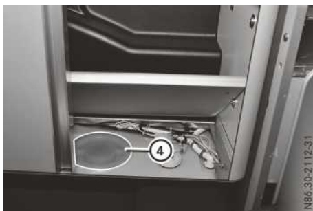
Reinigingsopening van het schoonwaterreservoir
