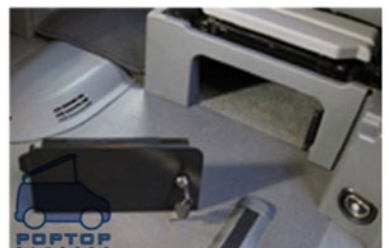
Het vilt op de bovenrand van het klepje plakken
